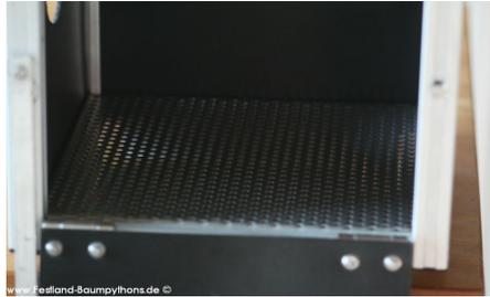
Edelstahllochblech mit 5mm großen Löchern zum Einsatz. Nach eigener Erfahrung läuft Flüssigkeit auf dem altbewährten Aluminiumlochblech mit 2mm Löchern schlechter ab. Tropfen bilden durch ihre hydrostatische Wirkung eine Art Haut, die nur schwer abfließt. Mit großen Löchern bleibt die Oberfläche des Gitters auch bei
